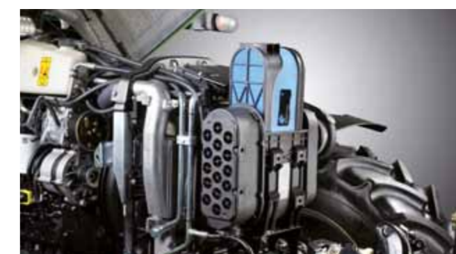
...das leicht zu reinigende Kühlsystem mit optionalem Viskolüfter.
