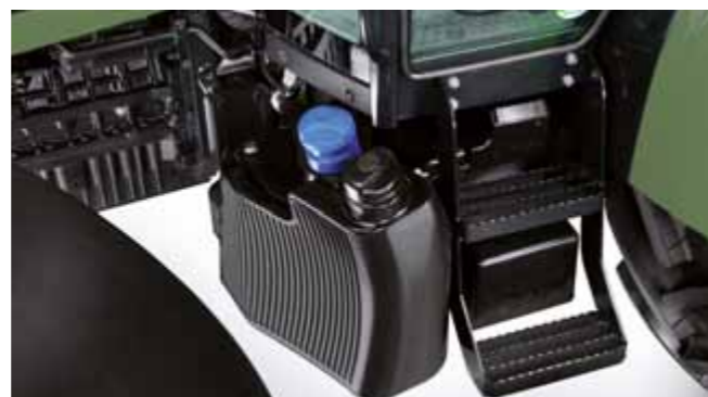
Kraftstofftank mit bis zu 145 Liter und 10 Liter AdBlue (je nach Modell) ermöglichen lange Arbeitsphasen.
