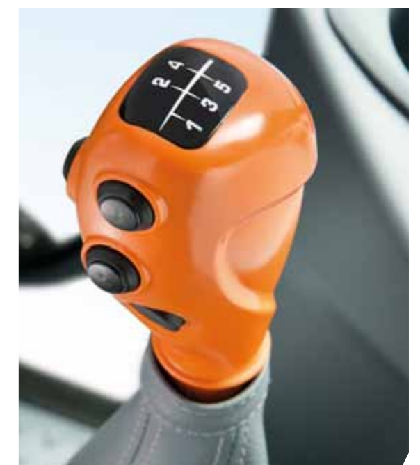
Gangschalthebel mit Kupplungstasten Comfort-Clutch und Powershift
