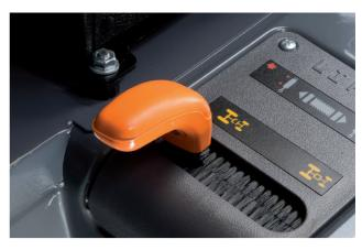
Der Allradantrieb kann manuell zugeschaltet werden, um den Zugbetrieb erheblich zu verbessern und die Bodenverdichtung zu reduzieren.
