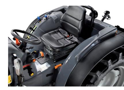
soliden Kabinenplattform, den gewölbten Glasflächen dem schalldämmendem Material für Kabinenboden und Dachinnenverkleidung zu verdanken. Für zusätzlichen Komfort sorgen Sonnenblenden, Belüftung und eine leistungsstarke Heizungsanlage.
